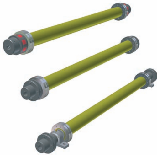
Typ 1 - Verbindung mit elastischen Kupplungen für niedrige Geschwindigkeiten und Achsabstände bis zu 2000 mm
